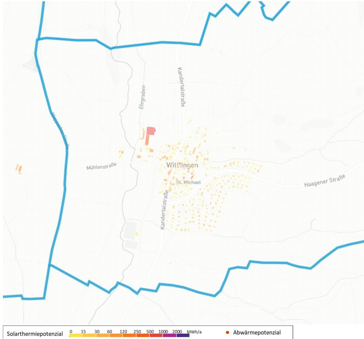
Abbildung 10: Innerörtliche Potenziale: Solarthermie und industrielle Abwärme in Wittlingen. (Die PV-Potenziale nutzen die identischen Flächen.) Zur besseren Erkennbarkeit ist ggf. nur ein Ausschnitt dargestellt.
