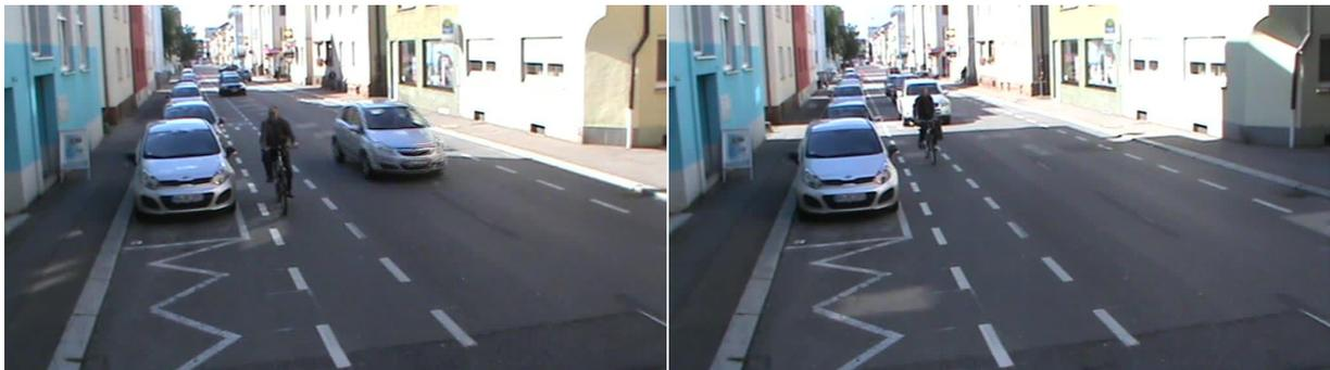
*Abb. 35: Bei beidseitigen Schutzstreifen erhöhen sich die Überholabstände, da sich nicht mehr an der Leitlinie orientiert werden kann (links). Bei Gegenverkehr wird selten überholt, der Kfz-Fahrer bleibt hinter dem Radfahrer (rechts)*
