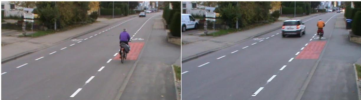
*Abb. 36: Schutzstreifen werden mittig befahren, wenn sie ausreichend dimensioniert sind (links). Die Reaktion auf die Beeinflussung durch den Kfz-Verkehr ist bei Schutzstreifen weniger ausgeprägt, d.h. das Abstandverhalten entwickelt sich positiv (rechts).*
