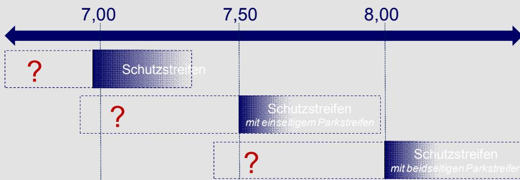
Abb. 2: Definition von schmalen Fahrbahnen
