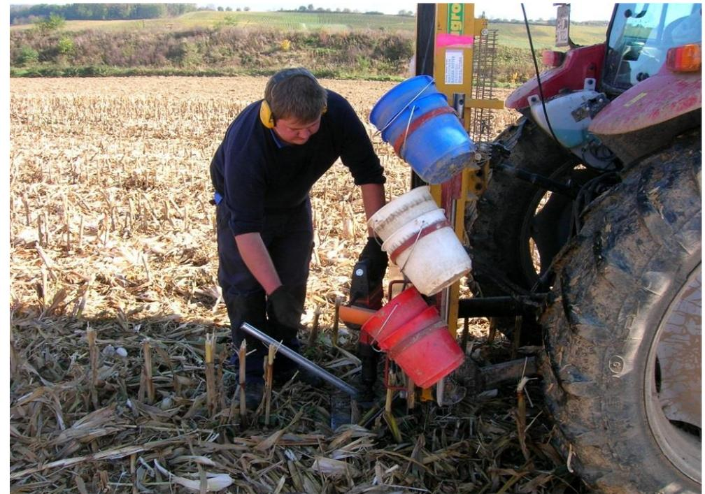
Entnahmegerät zur Ziehung von Bodenproben im Zeitraum 15.10. – 15.11.
