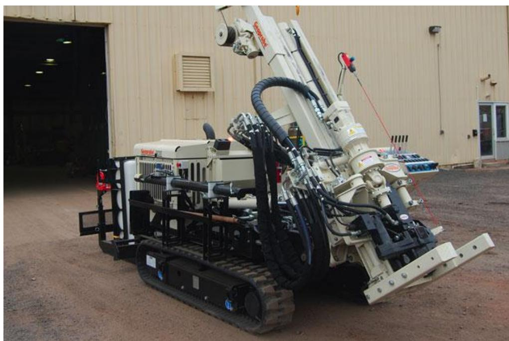
**Abbildung 4-5:** *Abbildung eines Direct-Push Gerätes für vorlaufende Beprobung*
