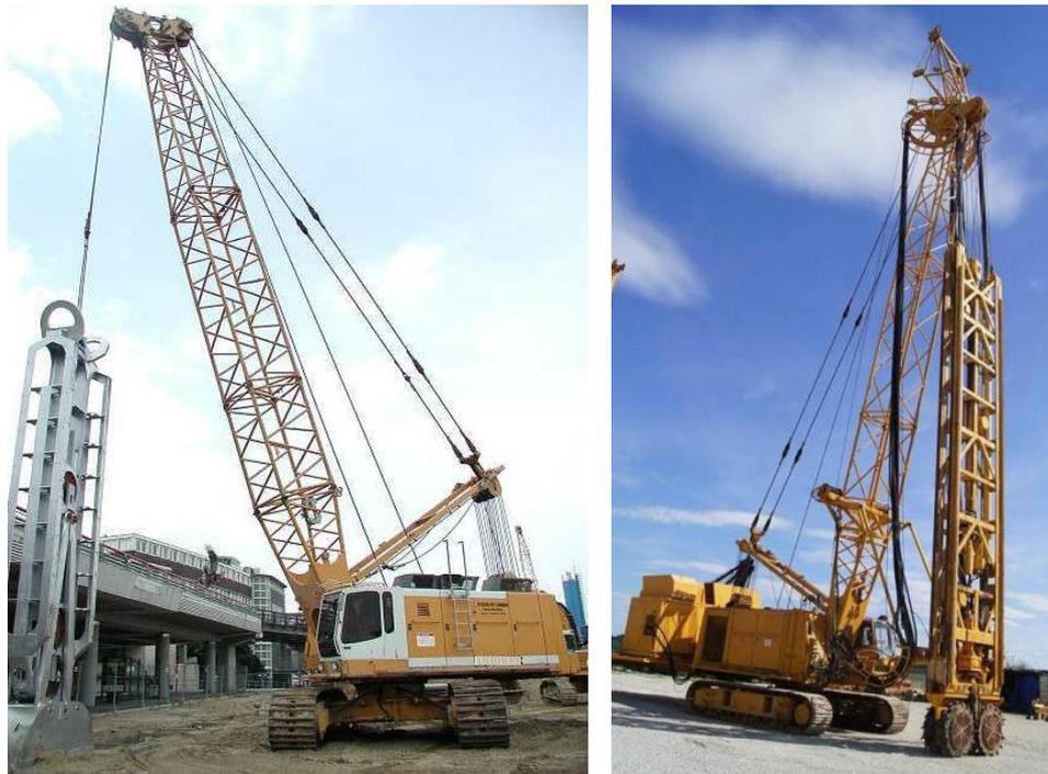
**Abbildung 4-6:** *Schlitzwandgreifer und -fräse (Beispielmodelle)*
